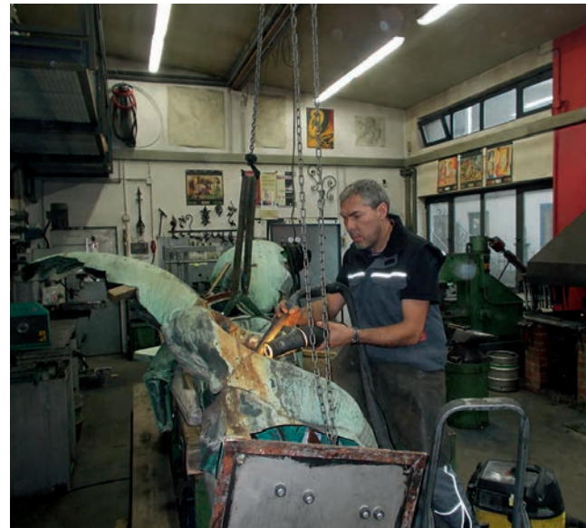
Trockenreinigung mit Druckluft und Absaugung
