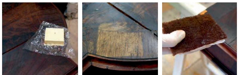
Lösemitteltest mit ethanolgetränkter Zellstoffkomresse
