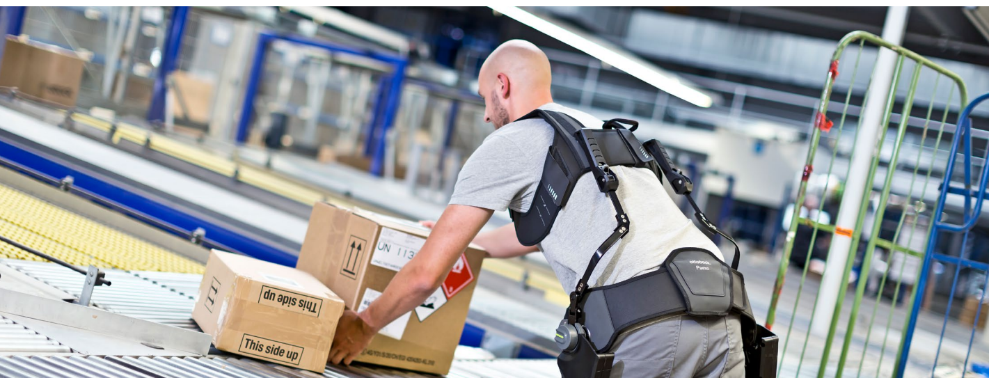
Passive Systeme speichern Energie aus Bewegungsabläufen und geben sie anschließend zielgerichtet wieder frei, um Belastungen zu reduzieren. Paexo Back von Ottobock | Bild: Ottobock
